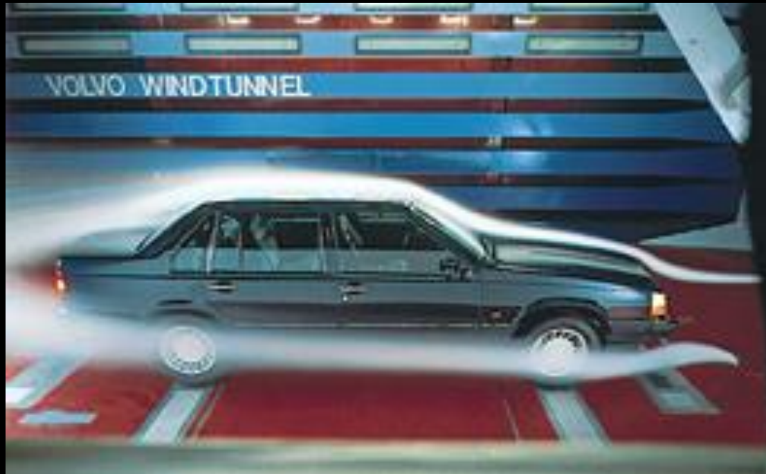
Fig. 11 – A “fumaça” revela as linhas de escoamento do ar passando por um automóvel, em um túnel de vento.
